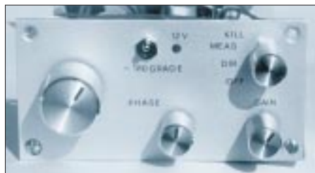
Bild 15: Frontseite mit Phasenreglern, 180°-Phasenumschalter, Verstärkungsregler und Betriebsmodusumschalter
