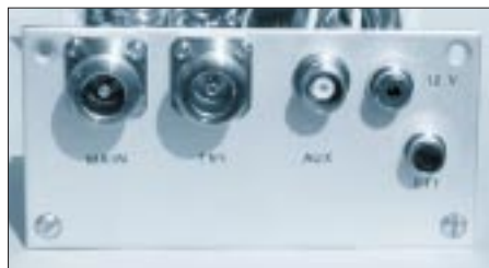
Bild 16: Alle notwendigen Anschlüsse befinden sich auf der Geräterückseite; verwechslungssicher die BNC-Hilfsantennenbuchse
